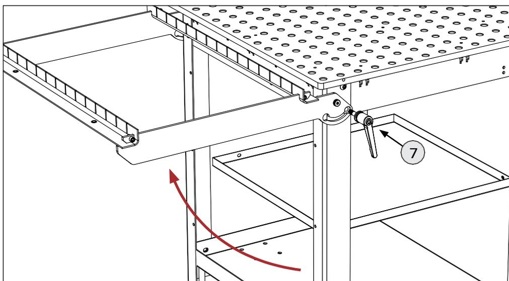
10. Tirez sur l'ensemble pour qu'il pivote de 90°. Tout en le tenant, prenez l'une des poignées et passez l'extrémité filetée dans le grand trou de la fente du bras de support. Entre le bras et le cadre, placez l'entretoise (Pièce : 6) et passez la vis de la poignée à travers elle. Vissez la poignée dans la plaque arrière filetée et assurez-vous que l'épaule de la poignée se verrouille dans le grand trou à l'extrémité de la fente.
