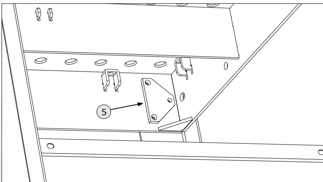
3. Prenez l'une des vis M10 originales retirées à l'étape 1 et revissez-la à travers le trou supérieur.
